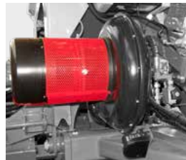
Fan dust filter
