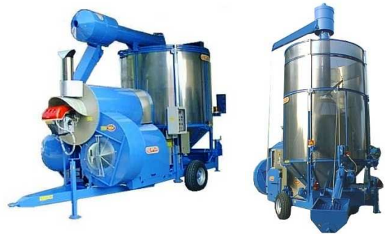
A 110 és 130 MZ típusú hőcserélős szárító szállítási és munkahelyzetben
